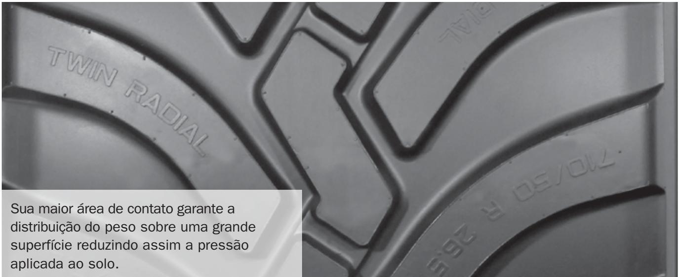
Sua maior área de contato garante a distribuição do peso sobre uma grande superfície reduzindo assim a pressão aplicada ao solo.
